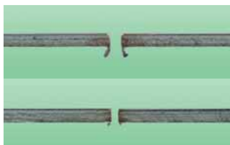
Detalhe do corte com disco de 1 mm em comparação com o disco de 0,8 mm. Corte mais rápido e preciso com menos rebarba.
